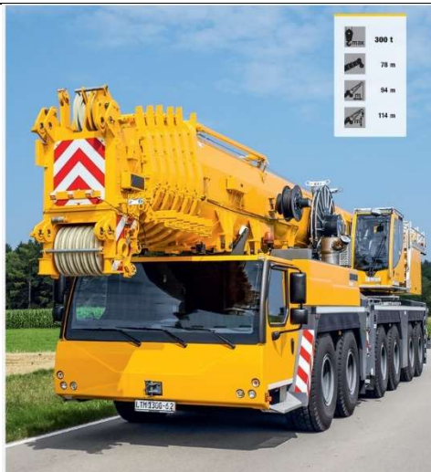
Imagem n.º 36 – guindaste 300t indicado para movimentação e içamento (modelo Liebherr).
